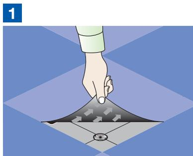
表面仕上げ材(タイルカーペットなど)の角を指先でつまみ上げて、開閉したいパネルにかかる4枚の表面仕上げ材を取り除いてください。
