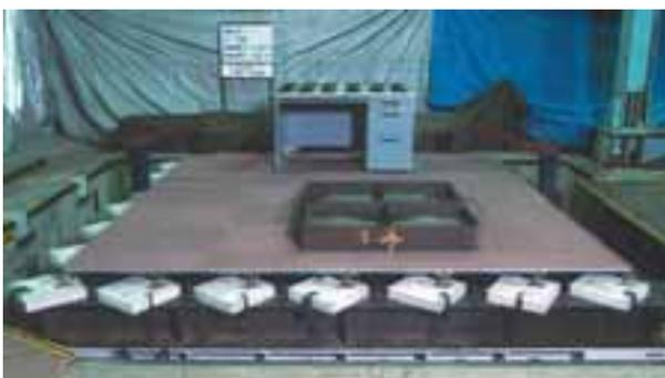
3000mm×3000mmのフロア上に等分布荷重(3000N)およびワークデスクによる荷重(1600N)を設置後、1.0Gの水平振動をかけます。
